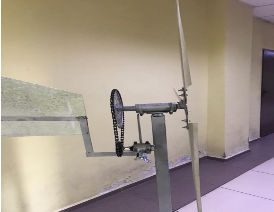
Сурет – 3.2. Жел генераторының басты элементтері
