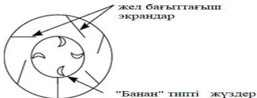
Сурет - 2.1. Жел бағыттайтын экрандамен және «Банан» типті жүздермен істелінген жел генераторының құрылымы
